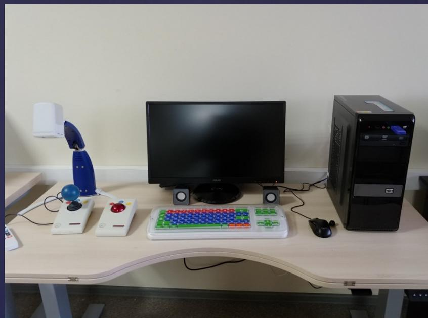
Автоматизированное рабочее место для инвалидов-колясочников с коррекционной техникой и индукционной системой.
